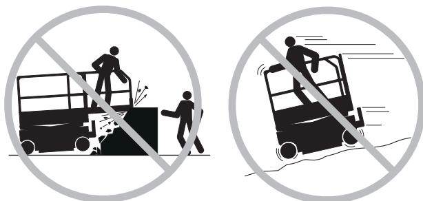
根據地面狀況、擁塞程度、坡度、人員位置和可能導致碰撞的任何其他因素，限制行進速度。
