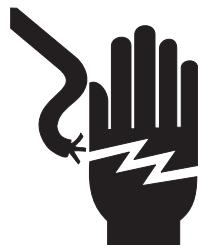
只將電池充電器連接到已接地的交流三相電源插座上。
