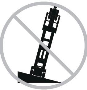
請勿把傾斜警鈴當成水平指示器。只有當機器傾斜時底盤上的傾斜警鈴才發出聲音。
